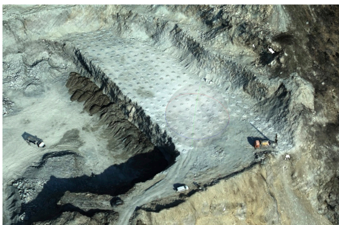
Рис. 4. Обуренный блок, снятый с беспилотного летательного аппарата с выделением зоны, перспективной для дифференциации параметров взрывной отбойки
