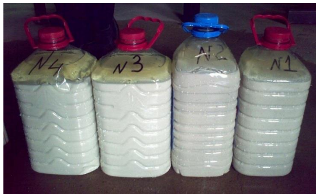
Рис. 6. Пробы исходного нового ионита (№ 3 и 4) в сравнении с пробами ионита, бывшего в эксплуатации (№ 1 и 2)
