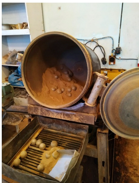
Рис. 2. Лабораторная шаровая мельница МШЛ-120
