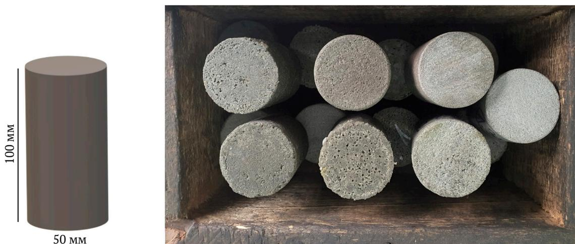
Рис. 1. Образцы геоматериалов для испытаний на трехосное сжатие
