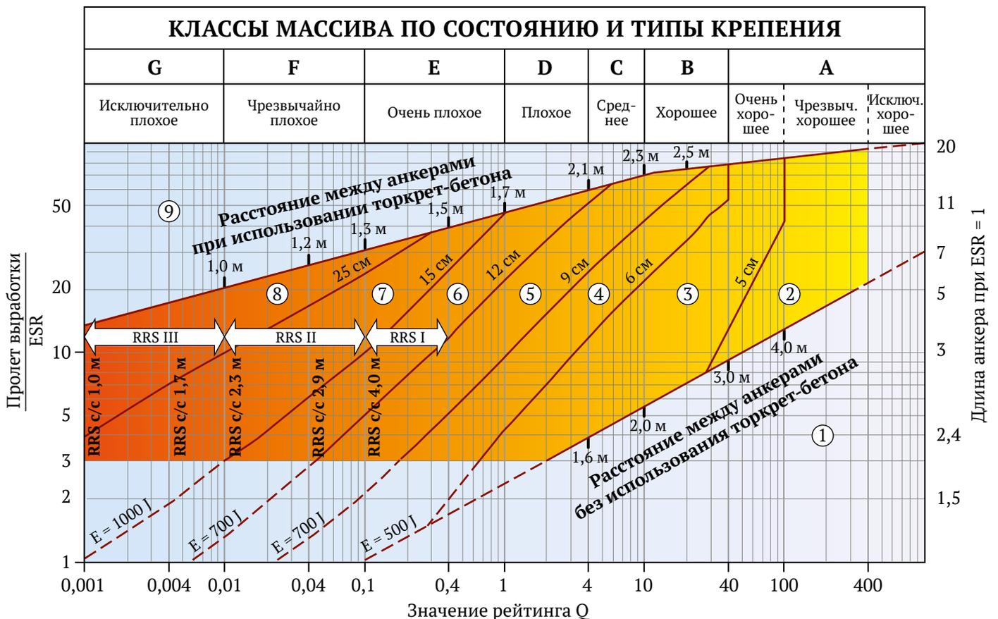
Рис. 10. Номограмма выбора параметров крепления выработок по рейтингу Q
