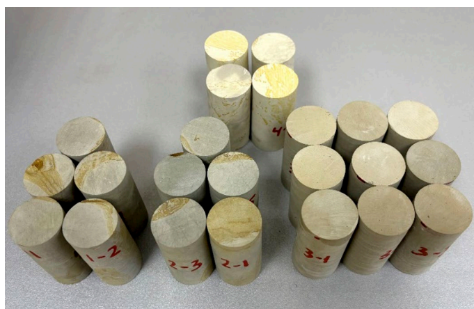
Рис. 2. Цилиндрические образцы силицитов (1, 2), окремненных доломитов (3) и опоки (4) для испытаний на одноосное сжатие
