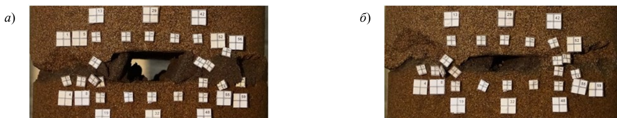
Рис. 6. Схема деформирования пласта при пересечении выработок
