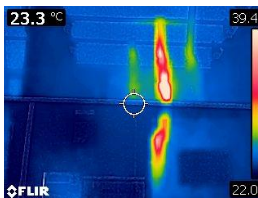
Рис. 7. Повышенный нагрев фазы В высоковольтного ввода (6 кВ) до 39 °С
