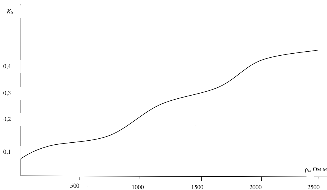
Рис. 1. График зависимости коэффициента ослабления пород в массиве ( K_0 ) от кажущегося сопротивления ( \rho_k )
