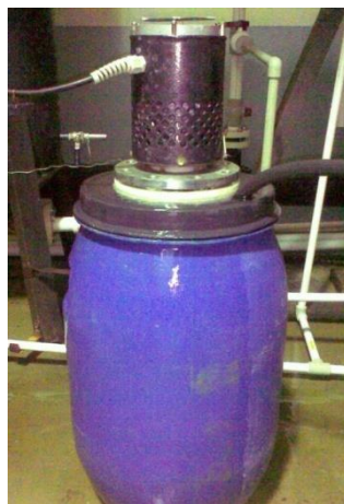
Рис. 5. Установка для исследования воздействия жесткого ультразвука на механическую прочность ионита
