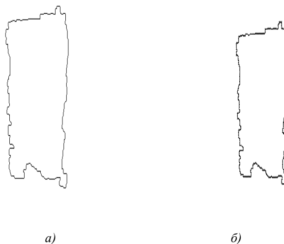
Рис. 4. Результаты отслеживания контура объекта: a – на прямоугольной сетке; б – на шестиугольной сетке
