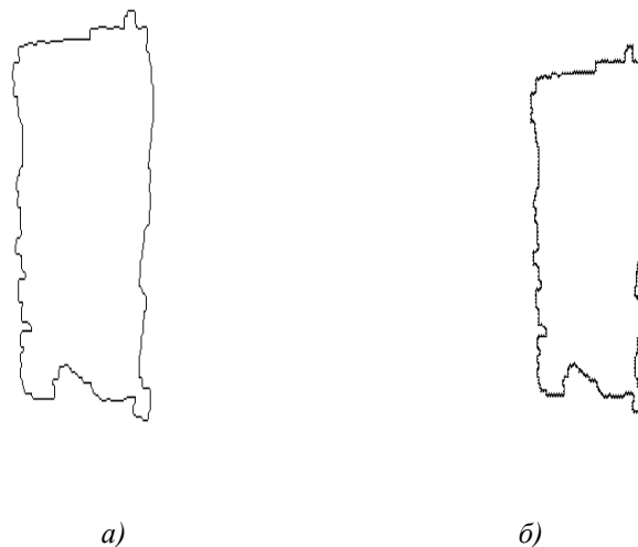
Рис. 4. Результаты отслеживания контура объекта: а – на прямоугольной сетке; б – на шестиугольной сетке
