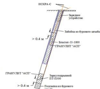
б) конструкция заряда
