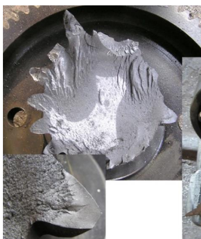
Рис. 7. Разрушение шестерен редукторов
