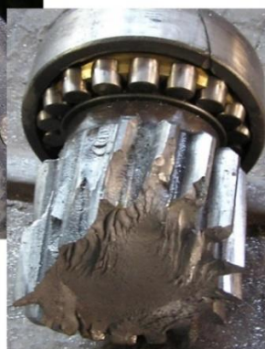
Рис. 7. Разрушение шестерен редукторов
