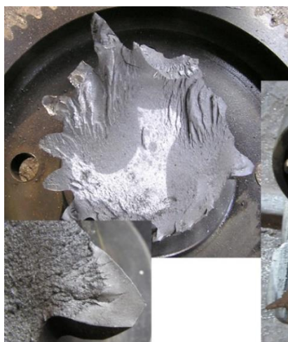
Рис. 7. Разрушение шестерен редукторов
