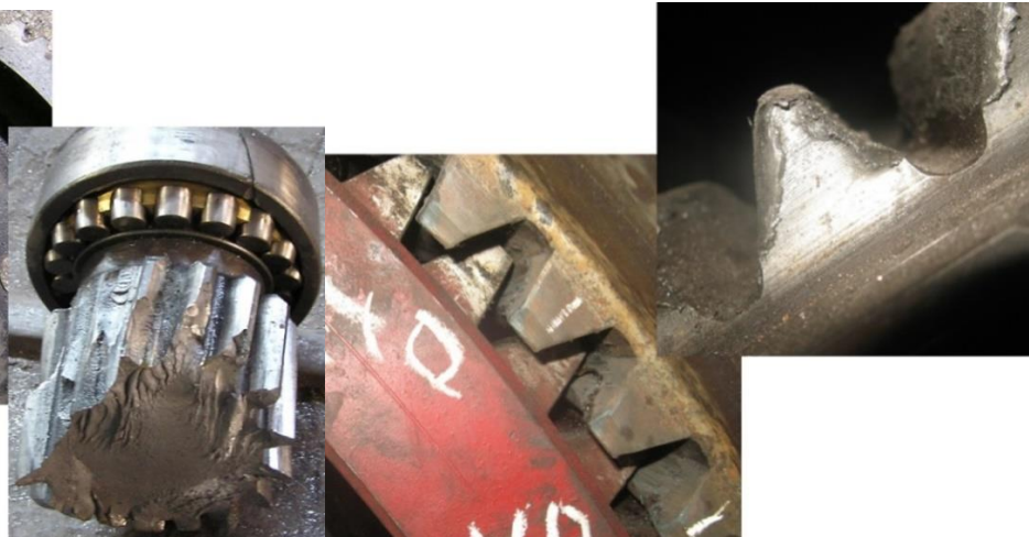
Рис. 7. Разрушение шестерен редукторов
