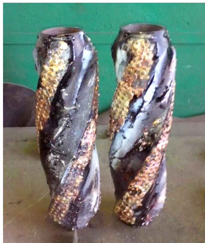
Рис. 1. Заготовку и готовый винтовой центратор производства АО «Волковгеология»
