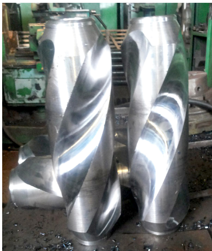
Рис. 1. Заготовку и готовый винтовой центратор производства АО «Волковгеология»
