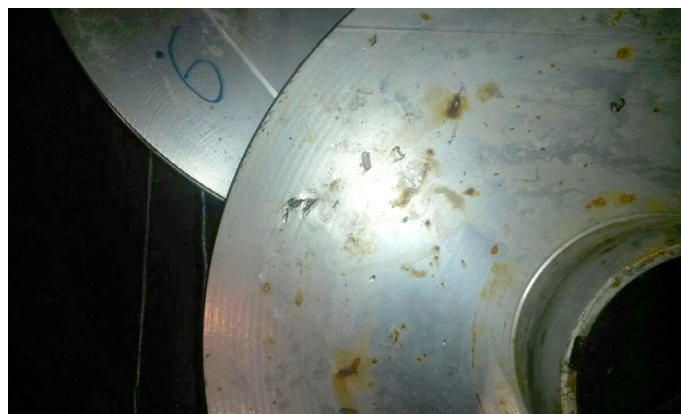
Рис. 5. Адгезионный износ поясков и дисков рабочих колес
