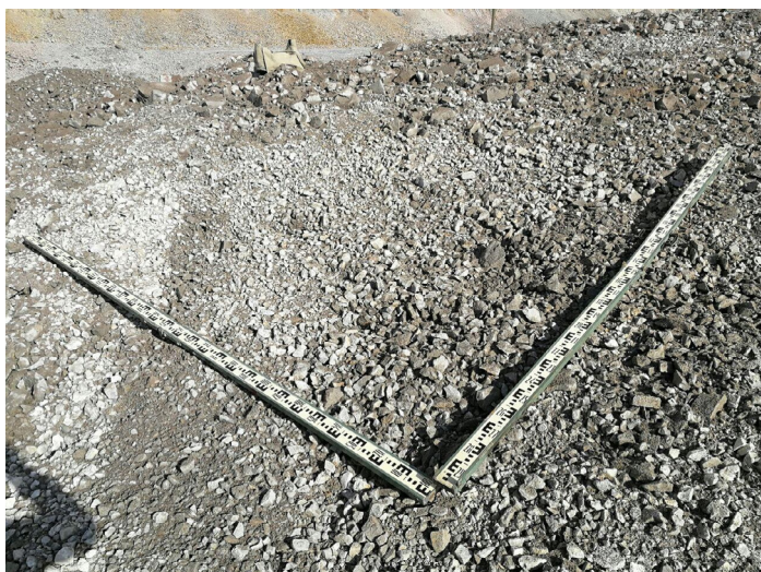
Рис. 11. Результаты промышленных взрывов при использовании разработанного способа дробления массива горных пород
