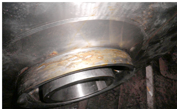
Рис. 4. Коррозионная пленка на поверхности изношенного пояска рабочего колеса
