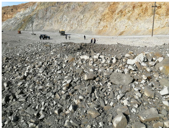
Рис. 10. Результаты промышленных взрывов при использовании базового способа дробления массива горных пород
