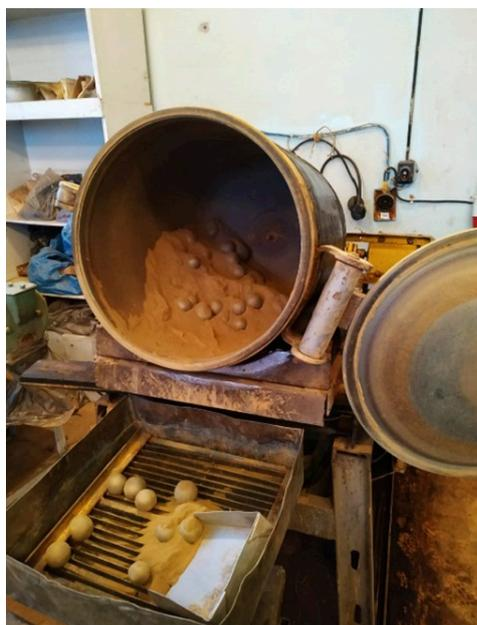
Рис. 2. Лабораторная шаровая мельница МШЛ-120
