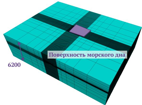
Рис. 3. Общий вид геомеханического грида
