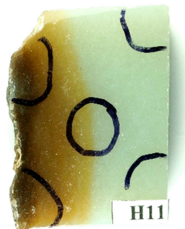
Рис. 4. Нефрит Н11 синевато-зеленый bG светлый l, умеренно сильная насыщенность света mst, корочка прокрашивания коричневая Brn (от светлой l до чрезвычайно темной exdk с сильной насыщенностью света st)
