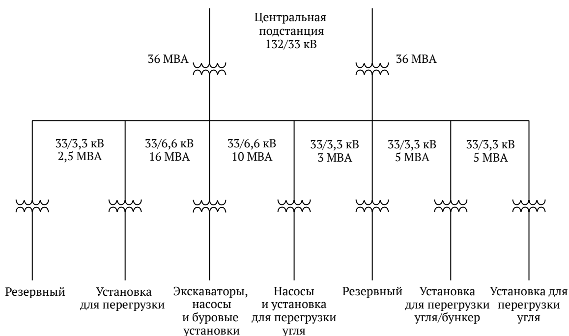
Рис. 3. Распределение электроэнергии в угольном разрезе
