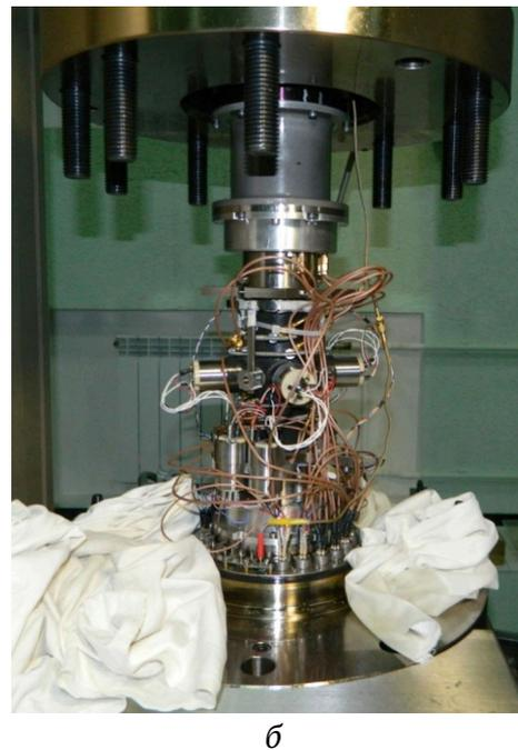
Рис. 5. Принципиальная схема проведения эксперимента (а) и образец, подготовленный к испытаниям в камере трехосного сжатия (б), с установленными датчиками акустической эмиссии:
