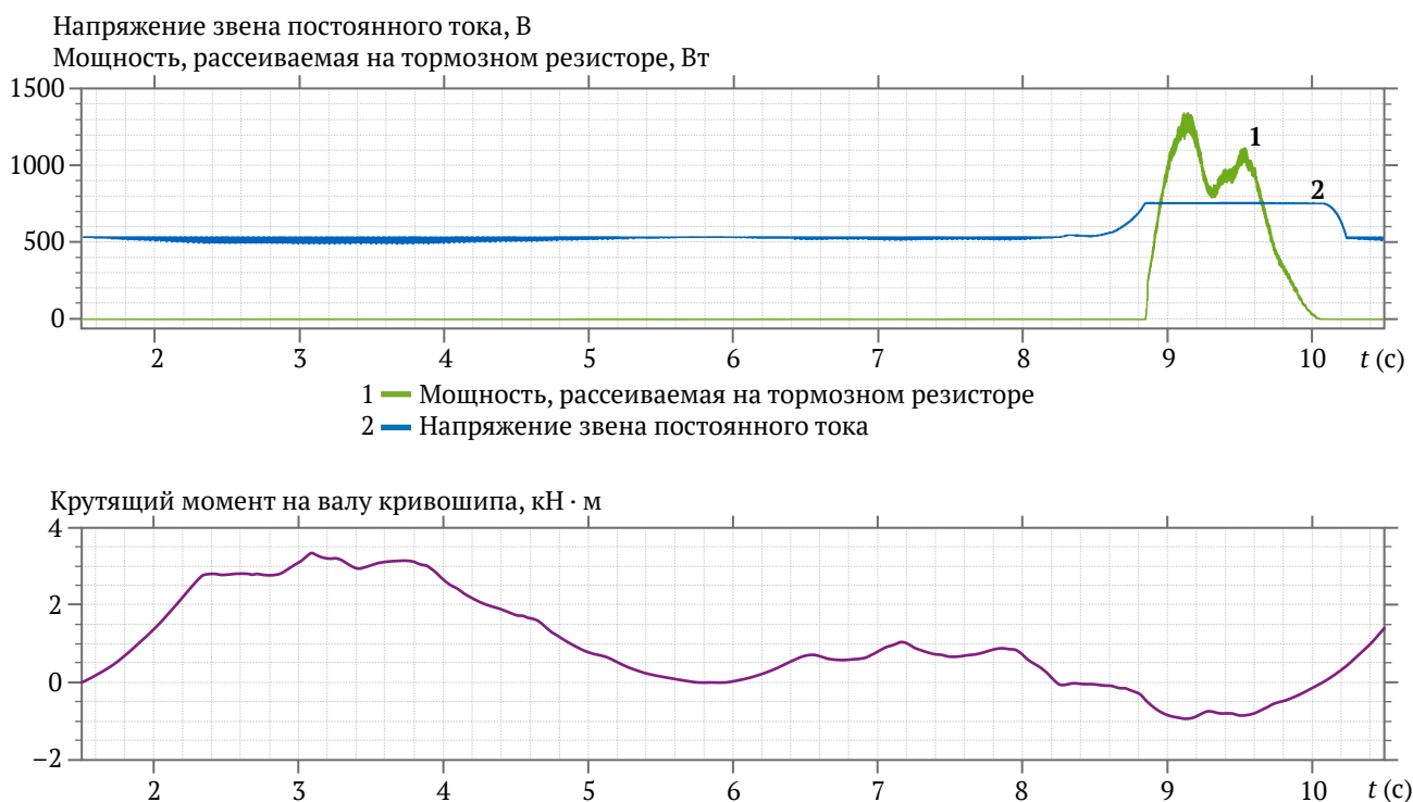
Рис. 3. Кривые напряжения звена постоянного тока и мощности, рассеиваемой на тормозном сопротивлении (верхний график), кривая крутящего момента на валу кривошипа с учетом действия противовесов (нижний график) при небалансе \approx 50\%
