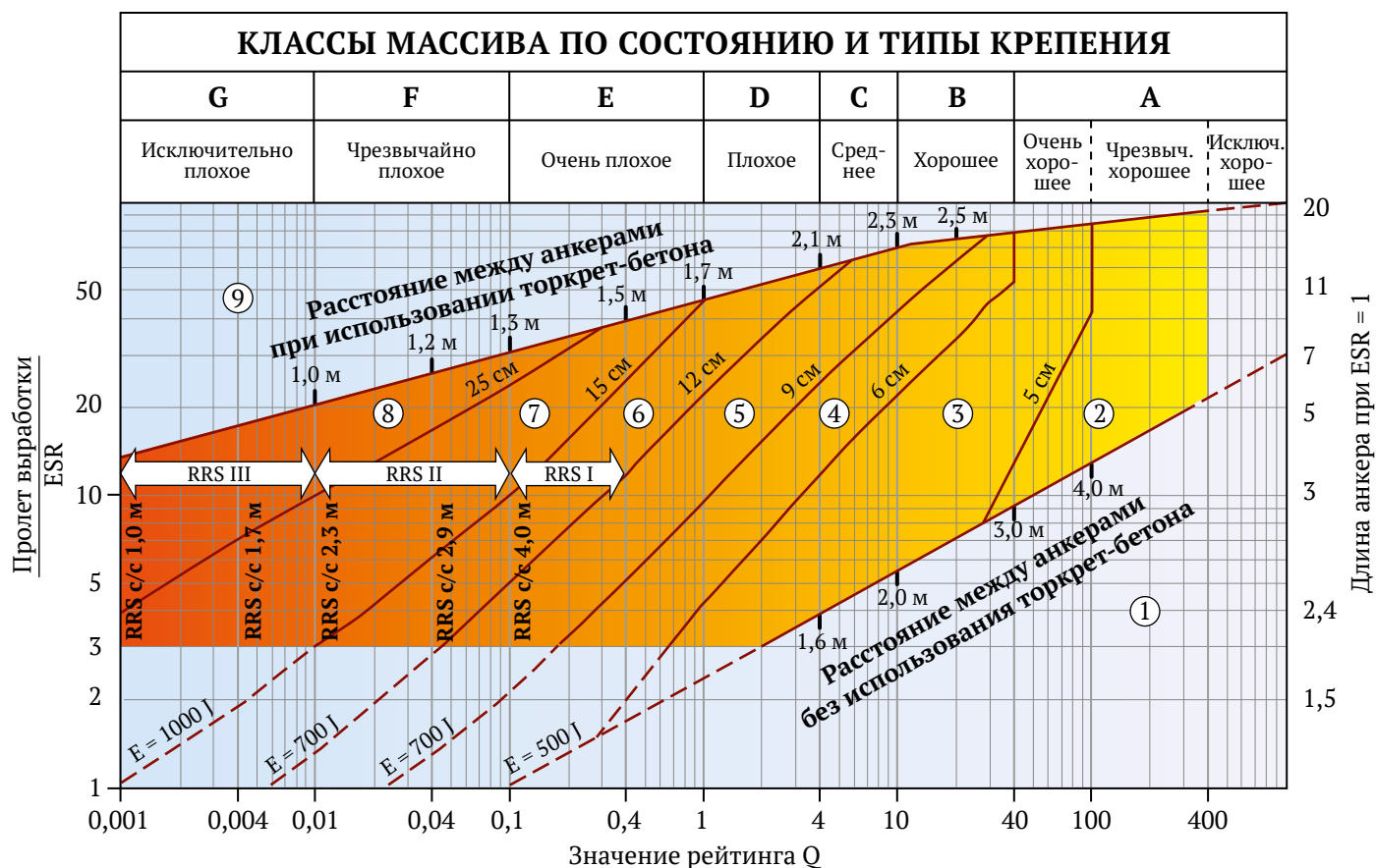
Рис. 10. Номограмма выбора параметров крепления выработок по рейтингу Q Источник: Using the Q-system. Rock mass classification and support design. NGI. 2015. 56 p.
