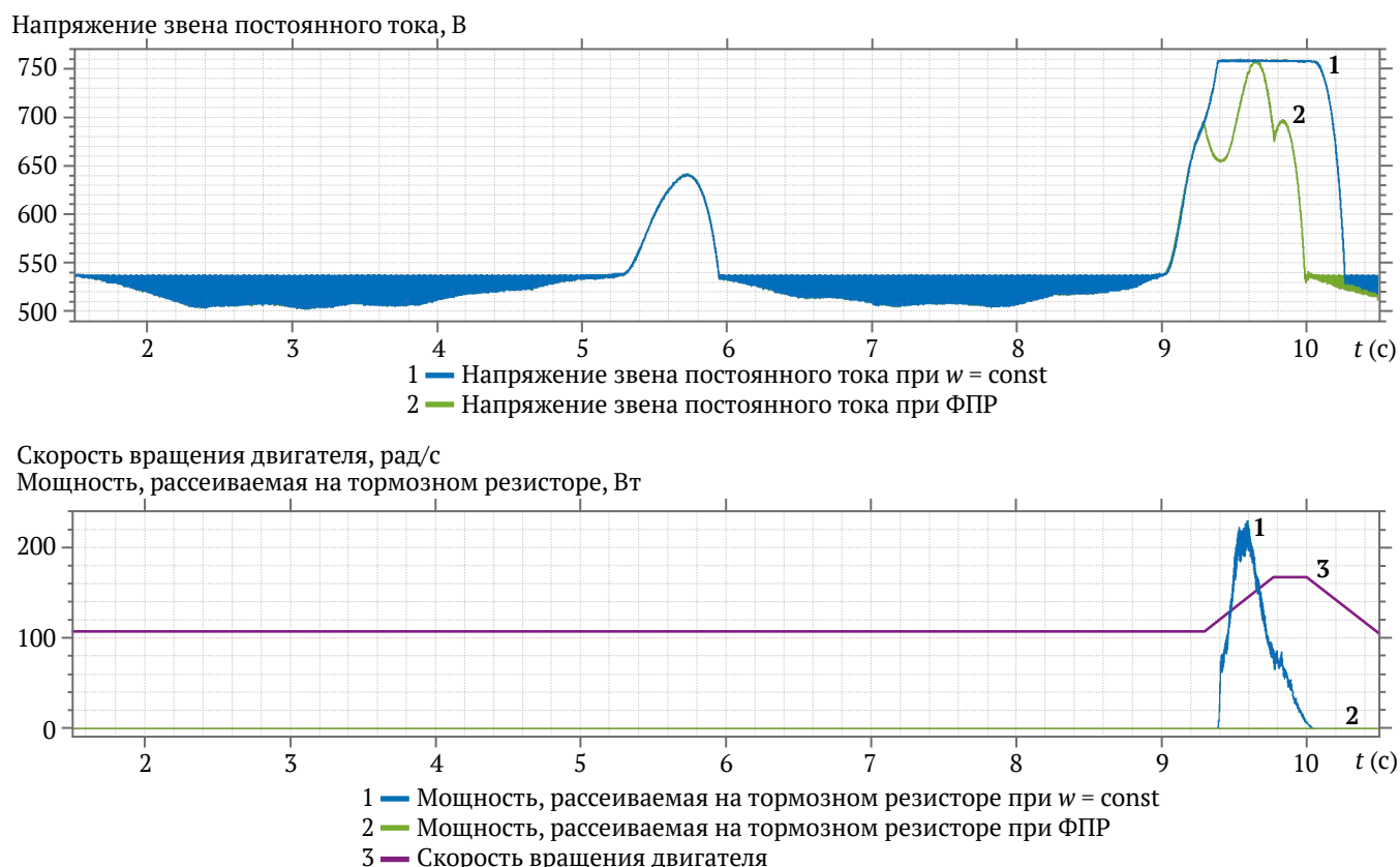
Рис. 5. Кривые напряжения звена постоянного тока (верхний график), кривые скорости и рассеиваемой на тормозном сопротивлении мощности (нижний график) при отключенной и при активной ФПР и небалансе \approx 5\%
