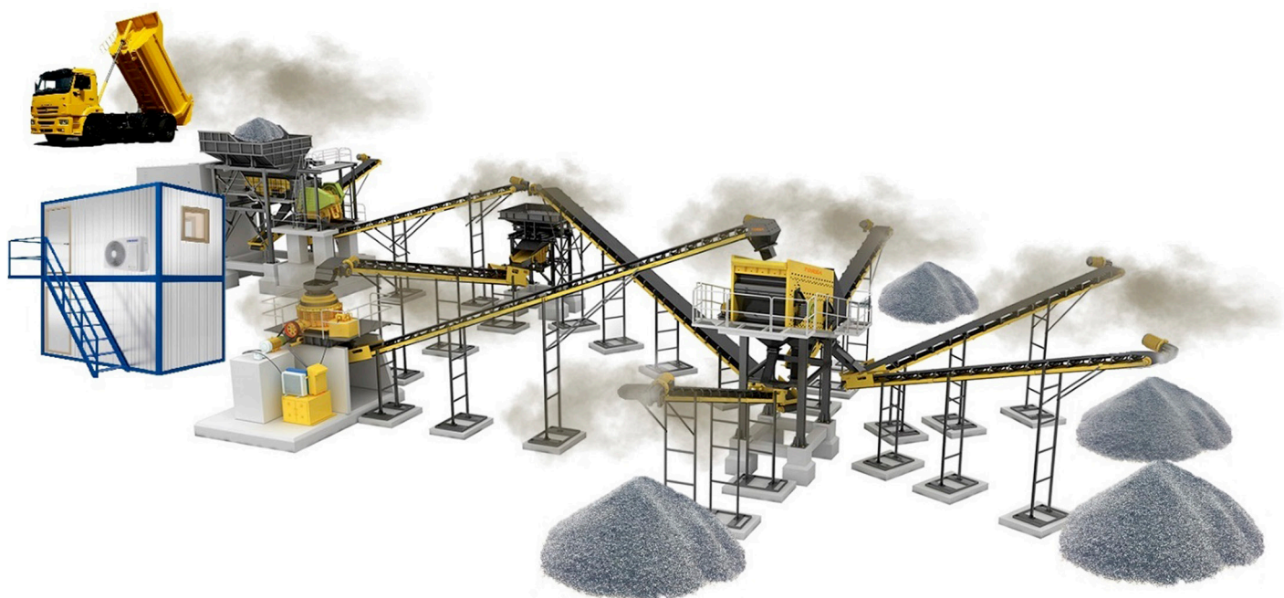
Рис. 2. Схема дробильно-щебеночного завода с иллюстрацией основных источников пылеобразования
