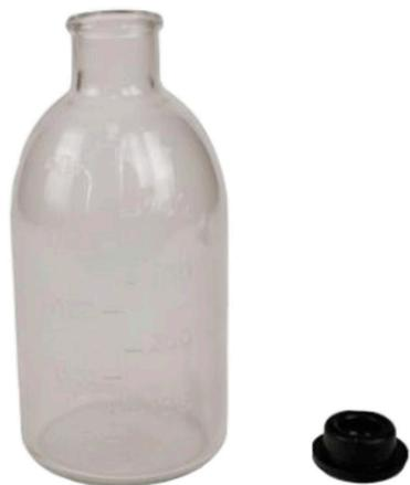
Рис. 1. Пробоотборник для определения концентрации горючих газов
